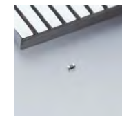
超小型積層 セラミックコンデンサ 0.25mm×0.125mm
